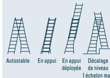
Autostable En appui En appui déployée Décalage de niveau 1 échelon maxi
